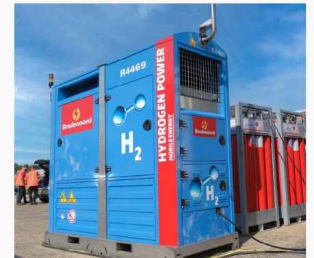
Afbeelding: een brandstofcel op locatie verbonden aan een (bundel van) H 2 -cilinders.
