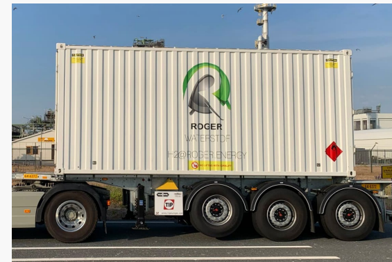
Afbeelding: een voorbeeld van een tanktainer met een containerized cilinderpakket op een los trailerchassis.
